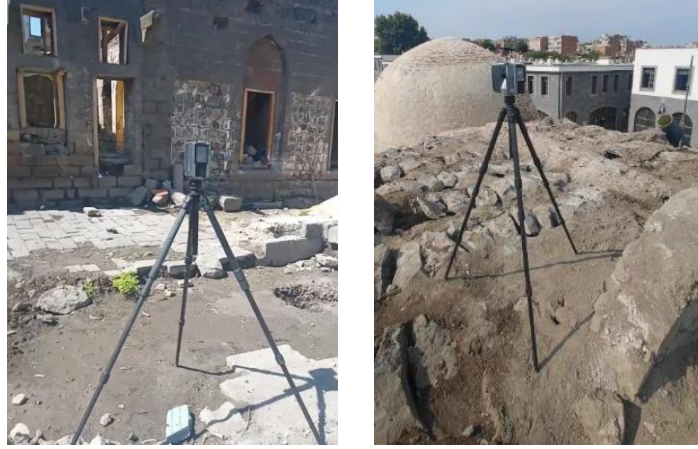
Şekil 6: Faro Focus Lazer Scanner aleti farklı açılardan yerleşimi Kaynak: Arşiv, 2023
