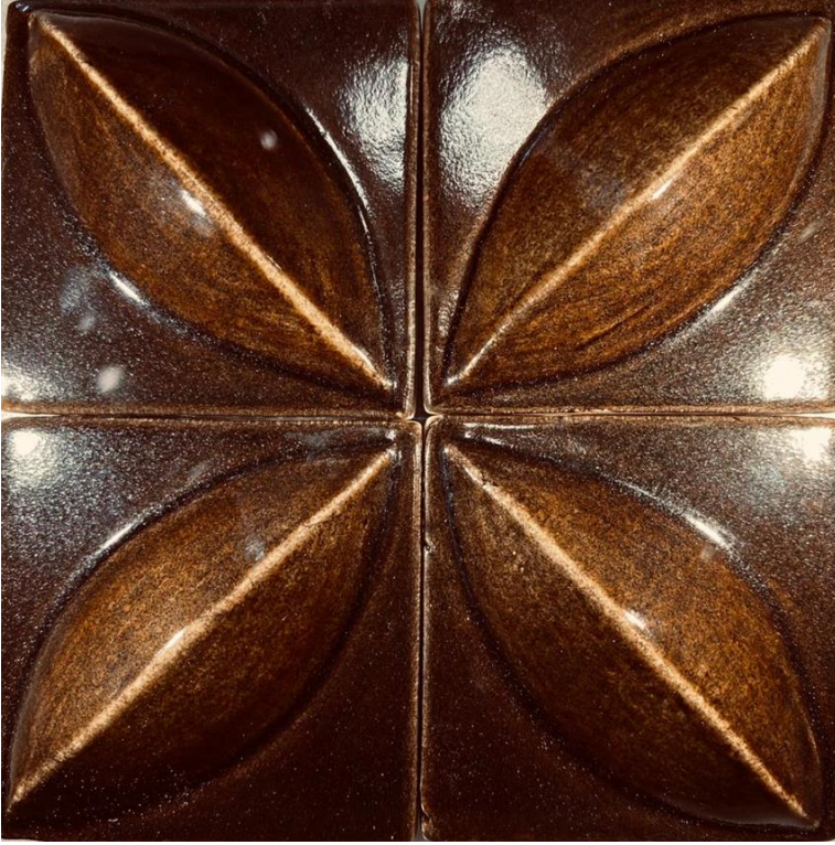
Şekil 6: B30 kodlu sır reçetesinin seramik pano üzerindeki yüzey görünümü, 1100°C, 13 x 13 cm, 2022.
