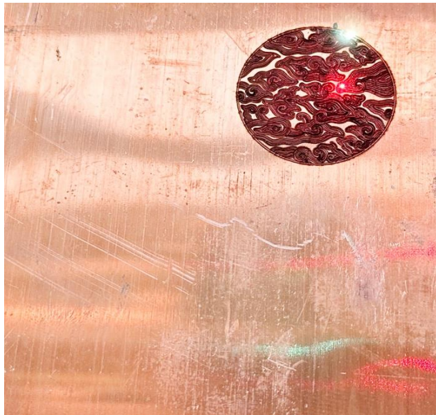
Resim- 6 Lazer ile kazıma işlemi
