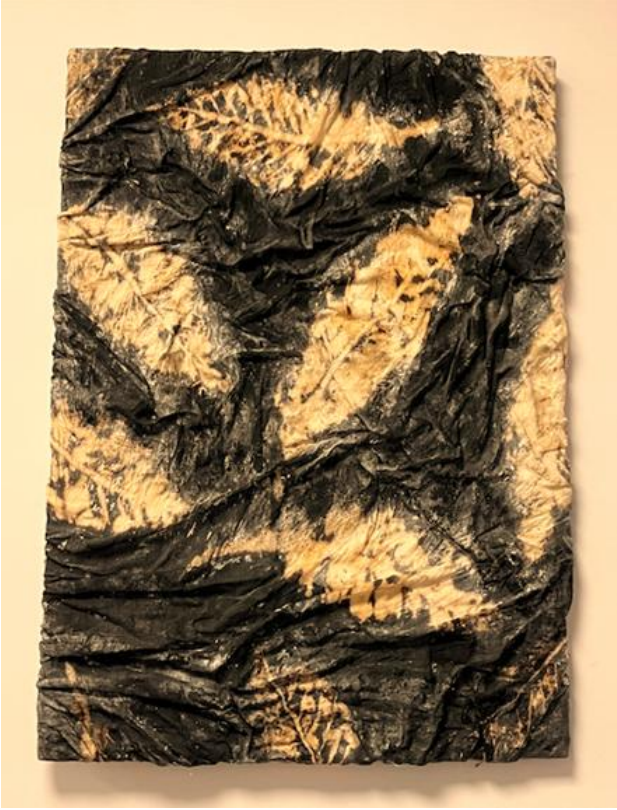
Şekil: 11-12 Tekstil atıkları ile alçı duvar panoları Kaynak: Yazar tarafından üretilmiştir.
