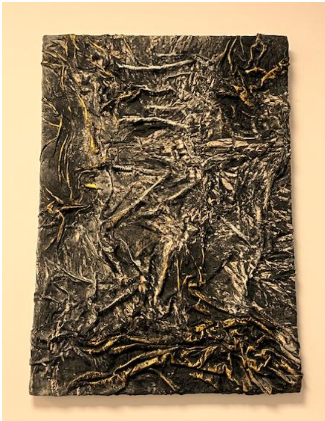
Şekil: 13-14 Tekstil atıkları ile alçı duvar panoları Kaynak: Yazar tarafından üretilmiştir.
