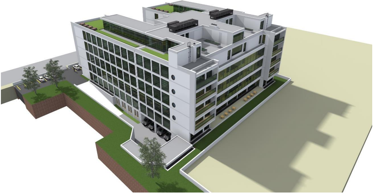
Şekil 12: Binanın Güneybatı Cehesi-Bina Çatısında Yeşil Çatı Uygulaması Görülebilir
