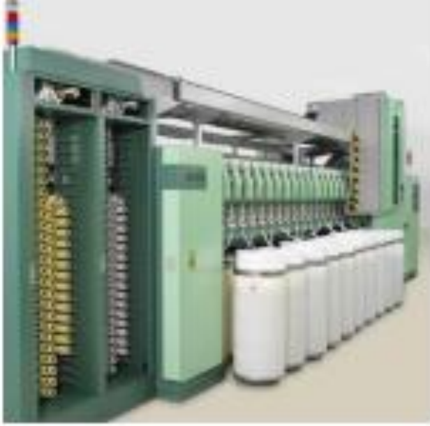
Resim 12. Open-End iplik makinası (Bebka, 2025)
