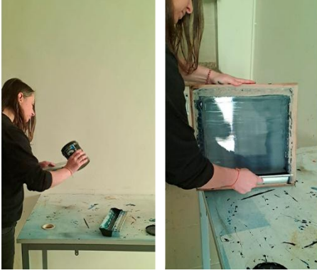
Şekil 33-34: Pozlama öncesi kalıplara emisyon sürme aşaması
