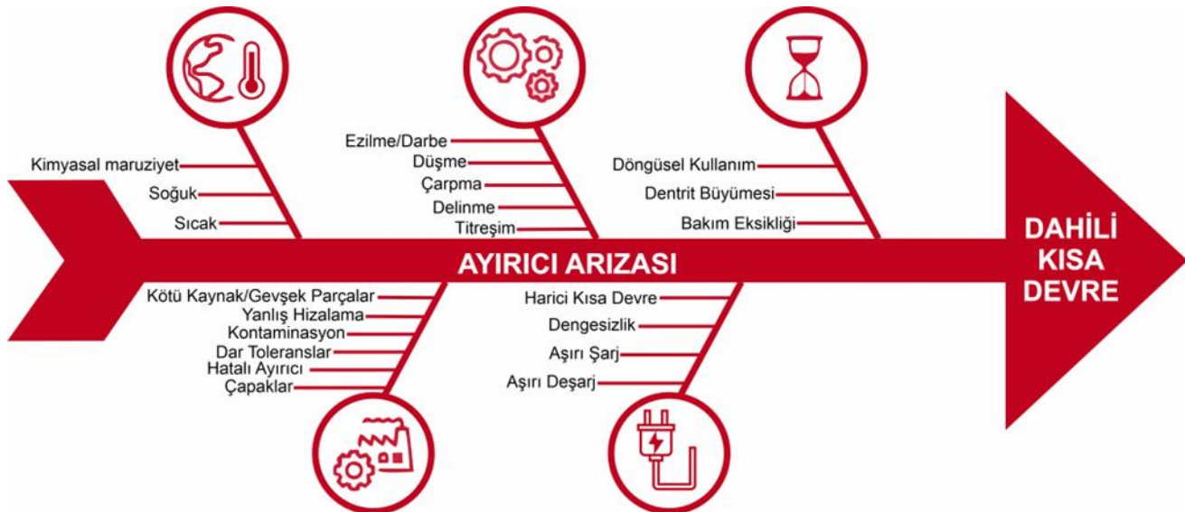
Şekil 1: Lityum-İyon Bataryalarda Termal Kaçak Nedenleri
