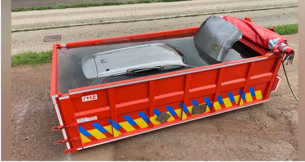
Şekil 9: Su Dolu Konteyner Kaynak: Firehouse, 2021.
