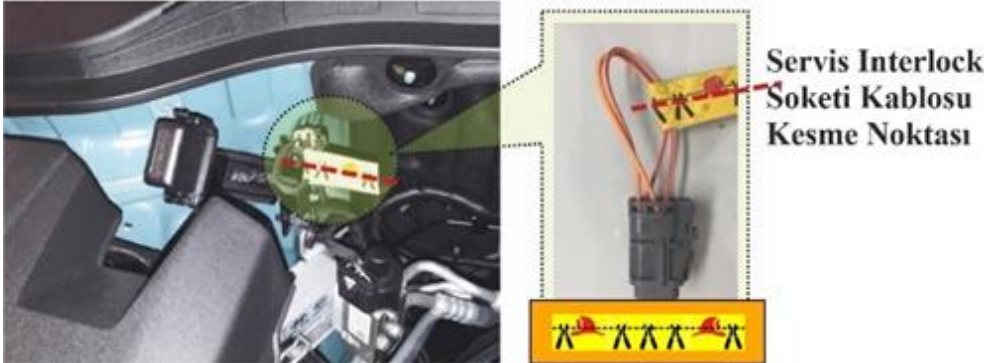
Şekil 4: Servis İnterlock Soketi Kaynak: HYUNDAI, 2023.
