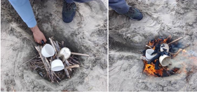
Görsel 3: ESC 1 döküm çamurunun açık pişirim, sahra fırında denemesi (2021)
