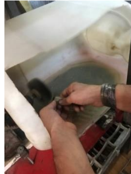
Resim 18. Tel gümüşün asitten çıktıktan sonraki hali Resim 19. Tel gümüşün asitten çıkartıldıktan sonra suda durulanması Resim 20. Gümüş telin fırça motoruyla temizlenmesi ve parlatılması Resim 21. Gümüş telin işleme hazır hali
