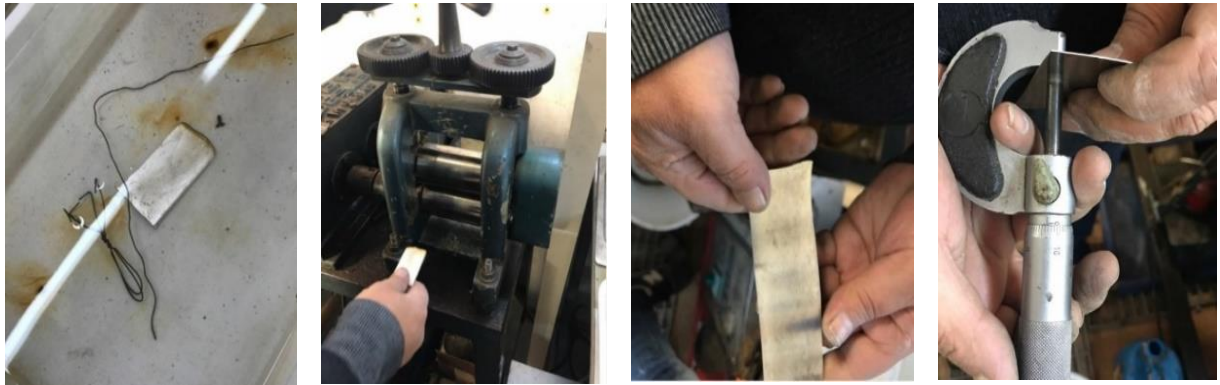
Resim 34. Suda bekletilen gümüş plaka Resim 35. Astar silindir makinesi Resim 36. Astar silindir makinesinde işlem görülmüş plaka gümüş Resim 37. Plaka gümüşün inceliğinin ölçmesi
