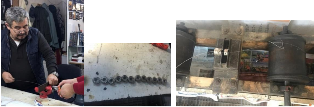
Resim 12. a) Telin plaka haddeden geçirilmesi. b) Sıra numaralarıyla dizilen hadde100,95 numaralı haddeden geçirdikten sonra 90,85 numaralı haddeden girilmektedir. Resim 13. Çıkırıkla ve haddeyle tel inceltme aşaması
