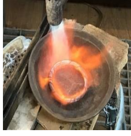
Resim 14. Telin beşer mikron haddelerde inceltilmesi Resim 15. İnceltilen gümüş telin tavllanması Resim 16. Gümüş telin aside atılmadan önceki hali Resim 17. Örmce cebenin sülfür asitte beklemesi
