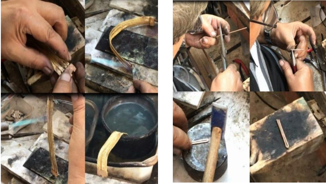
Resim 56. Örne cebeyle süs kilidin birleşmesi Resim 57. Anahtar yapımı
