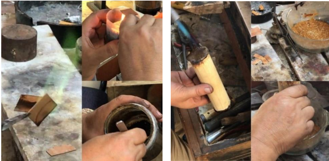
Resim 48. Mum isiyile aktarılan desenin sabitleştirilmesi Resim 49. Tahta rokelayı ısıtıp ve gomalağa batırılması
