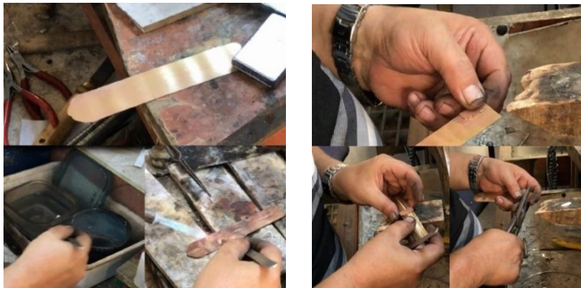
Resim 44. Altın plakanın tavlayarak düzleşmesi ve beyazlaması Resim 45. Altın plakanın süs kilit yapımı plakanın ölçüsü ve kesilmesi
