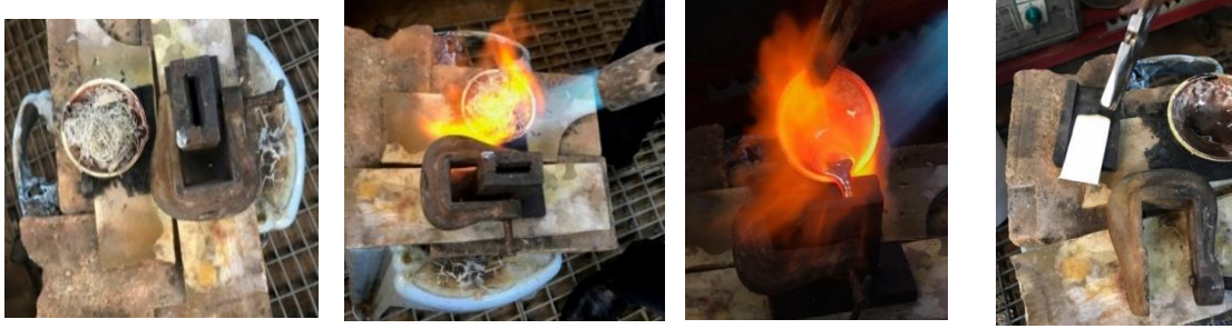
Resim 30. Seramik pota içinde hurda gümüş ve astar derece (kalıp) Resim 31. Teneker dökerek, seramik pota içinde eritilen hurda gümüşler Resim 32. Eritilen gümüşün kalıp içine dökülmesi Resim 33. Kalıbın içinden çıkarılan gümüş plaka
