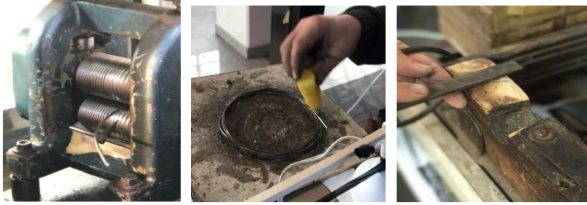
Resim 9. Tel silindir makinesinde inceltip ve uzatılan tel Resim 10. Telin bal mumuyla yağlanması Resim 11. Gümüş telin uçlarını eğe ile inceltmesi
