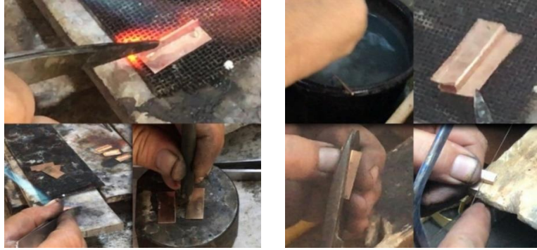
Resim 52. Kaynatarak parçaların birleşmesi Resim 53. Kaynatılan ve birleşen parçaların küçük parçalara bölünmesi
