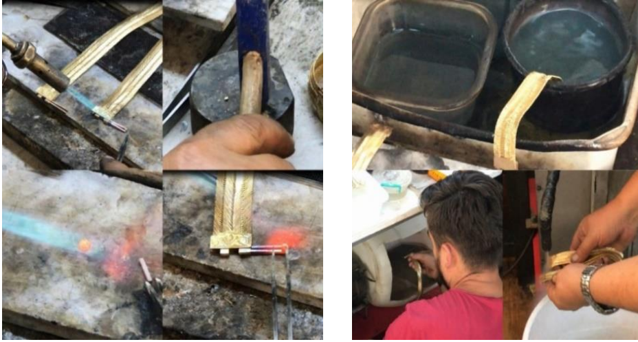
Resim 61. Anahtar topunun hazırlanması ve kaynatılması Resim 62. Örne cebinin beyazlatılması ve parlattırılması
