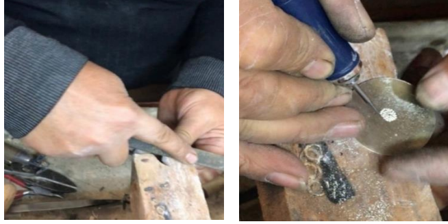
Resim 42. Eğe ile pürüzsüzlerin temizlenmesi Resim 43. Gravür aletiyle, noktaların koyulması (Nokta tekniği)
