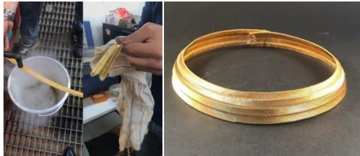
Resim 28. Örme cebenin buhar makinesinde parlaması ve bezle kurulanması Resim 29. Örme cebenin bitmiş hali
