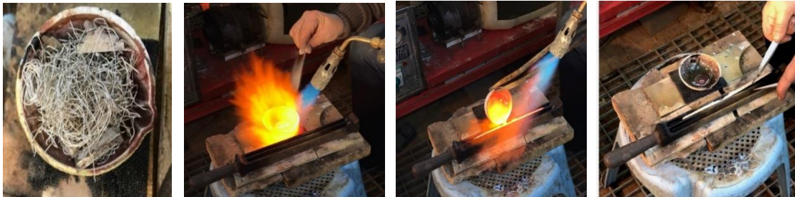
Resim 3. Seramik pota içinde hurda gümüş Resim 4. Hurda gümüşlerin teneker dökerek eritilmesi Resim 5. Eritilen gümüşün astar derece içine dökülmesi Resim 6. Eritilmiş gümüşün kalıptan çıkarılması
