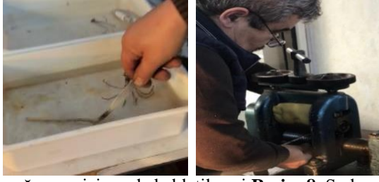
Resim 7. Kalıptan çıkarılan gümüşün soğuması için suda bekletilmesi Resim 8. Sudan çıkarılan gümüşün tel silindir makinesinden geçirilmesi
