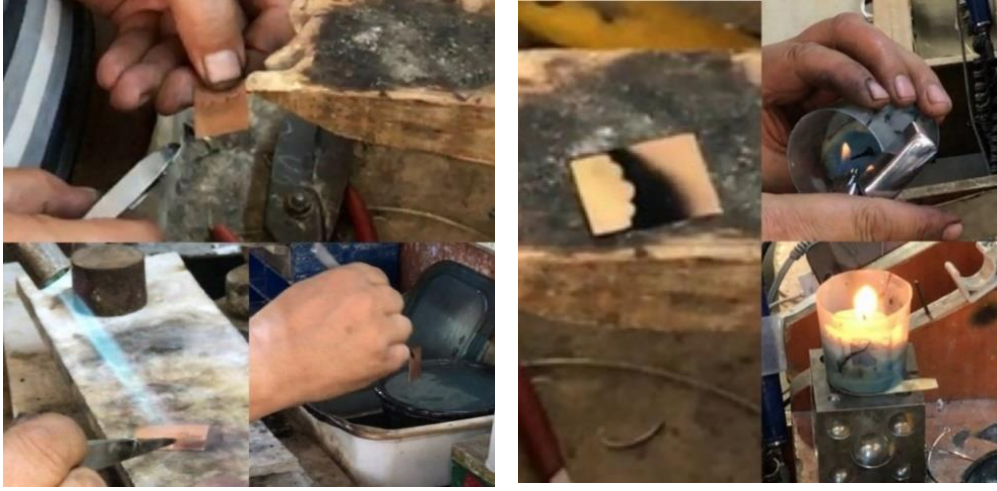
Resim 46. Kesilen plakanın düzleşmesi ve beyazlaması Resim 47. Mum isiyile altın plakanın üzerinde desen aktarma
