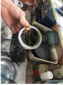
Resim 18. Tel gümüşün asitten çıktıktan sonraki hali Resim 19. Tel gümüşün asitten çıkartıldıktan sonra suda durulanması Resim 20. Gümüş telin fırça motoruyla temizlenmesi ve parlatılması Resim 21. Gümüş telin işleme hazır hali
