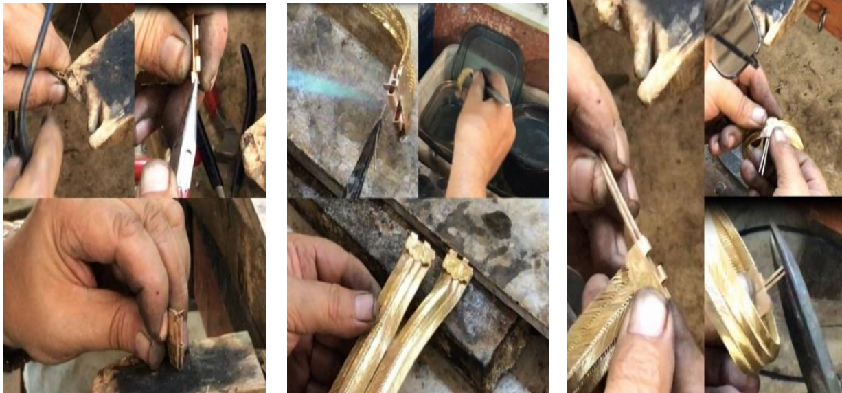
Resim 58. Kilit yapımı Resim 59. Tavlama işleminde beklenmesi Resim 60. Anahtar ölçüsünün alınması
