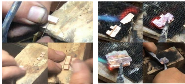
Resim 54. Kesilen küçük parçaların yerleştirilmesi Resim 55. Süs kilit ve kilidin kaynatılarak birleşmesi
