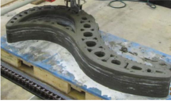
Şekil 4: 3B yazıcı teknolojiyle üretilen beton objenin pürüzsüz olması için manuel olarak düzeltme işleminin yapılması Kaynak: Le vd., 2012
