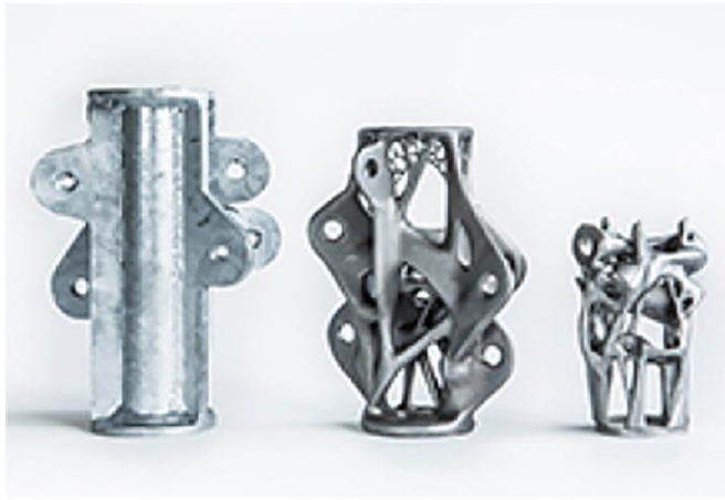
Şekil 7: 3B yazıcı teknolojiyle üretilen metal bağlantı elemanları Kaynak: Camacho vd., 2018
