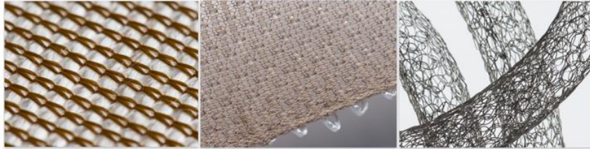
Şekil 21. Fonksiyonel Özelliğe Sahip İplikler ile Üretilen Örme Yapıları, (URL-13).
