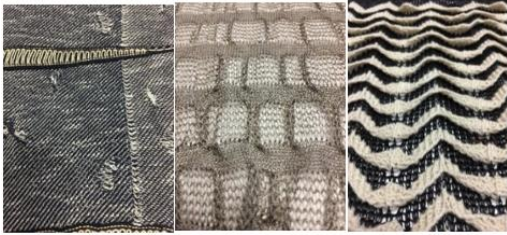
Şekil 7. Stoll, Düz Örme Makinesinde Farklı İplik ve Örgü Teknikleri Uygulaması.
