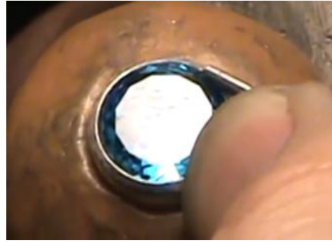
Fotoğraf 13 ve 14. Metalin taşta sıvanması işlemi ve çapak temizleme işlemi.
