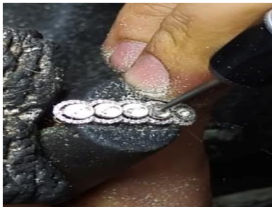
Fotoğraf 9 ve 10. Elmas yuvası açma işlemi ve elmas taşların mıhlama işlemi
