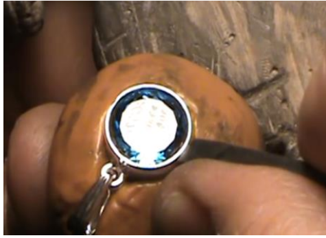
Fotoğraf 13 ve 14. Metalin taşta sıvanması işlemi ve çapak temizleme işlemi.
