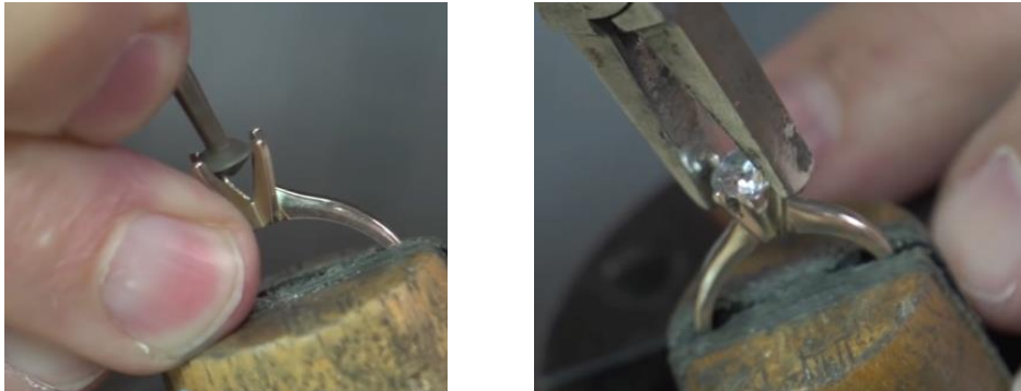
Fotoğraf 21 ve 22. Dört tırnaklı yüzük kolu üzerine zirkon taş mihlama işlemi.
