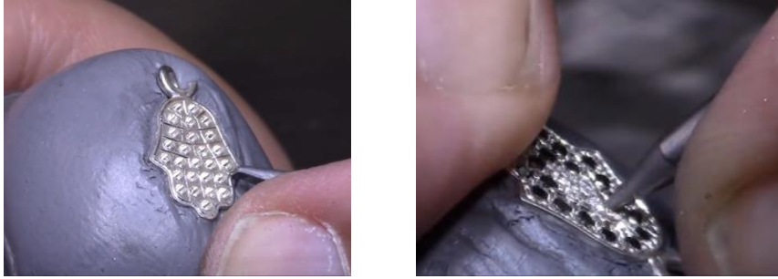
Fotoğraf 19 ve 20. Kâğıttan pul kesme işlemi, tırnak çıkarma işlemi ve taşların takılması
