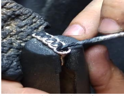
Fotoğraf 11 ve 12. Taş kenarının temizlenmesi işlemi ve oksitlenme işlemi
