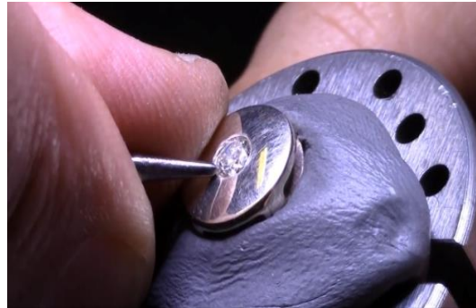
Fotoğraf 15 ve 16. Taş yuvası açma ve taş mıhlama işlemi.
