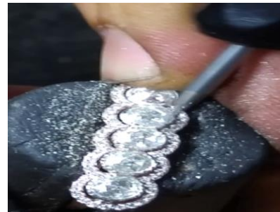
Fotoğraf 9 ve 10. Elmas yuvası açma işlemi ve elmas taşların mıhlama işlemi
