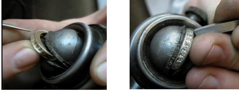
Fotoğraf 17 ve 18. Taş yuvası açma işlemi ve taşların sıvama işlemi
