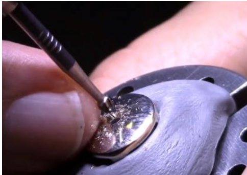
Fotoğraf 15 ve 16. Taş yuvası açma ve taş mıhlama işlemi.
