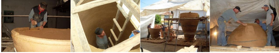
Şekil 14. Gövdenin ve kulp yataklarının şekillendirilmesi (Fotoğraflar Ergün Arda, 2012).
