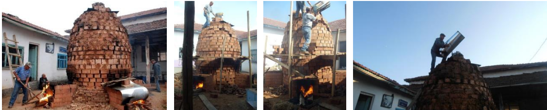
Şekil 18. Büyük küp tuğla fırını ve pişirim görüntüleri (Fotoğraflar (hbr, 2020) ve Ergün Arda, 2012)
