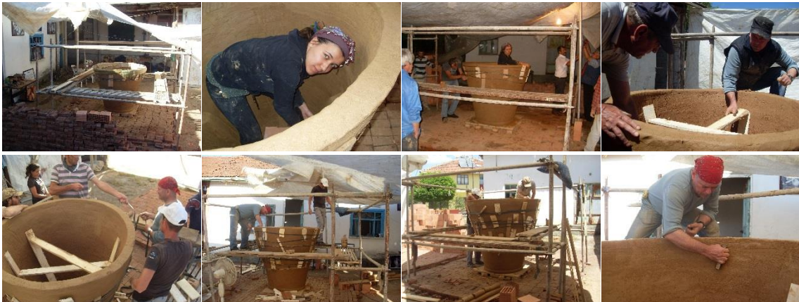
Şekil 13. Şekillendirme aşamaları ve 2m yüksekliğe yaklaşan küp (Fotoğraflar Ergün Arda, 2012).
