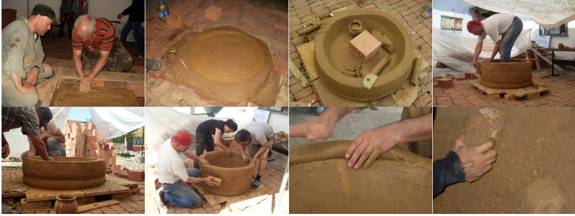
Şekil 11. Vakum preste kil sargı çekimi ve formun başlangıç şekillendirme aşamaları (Fotoğraflar Ergün Arda, 2012).
