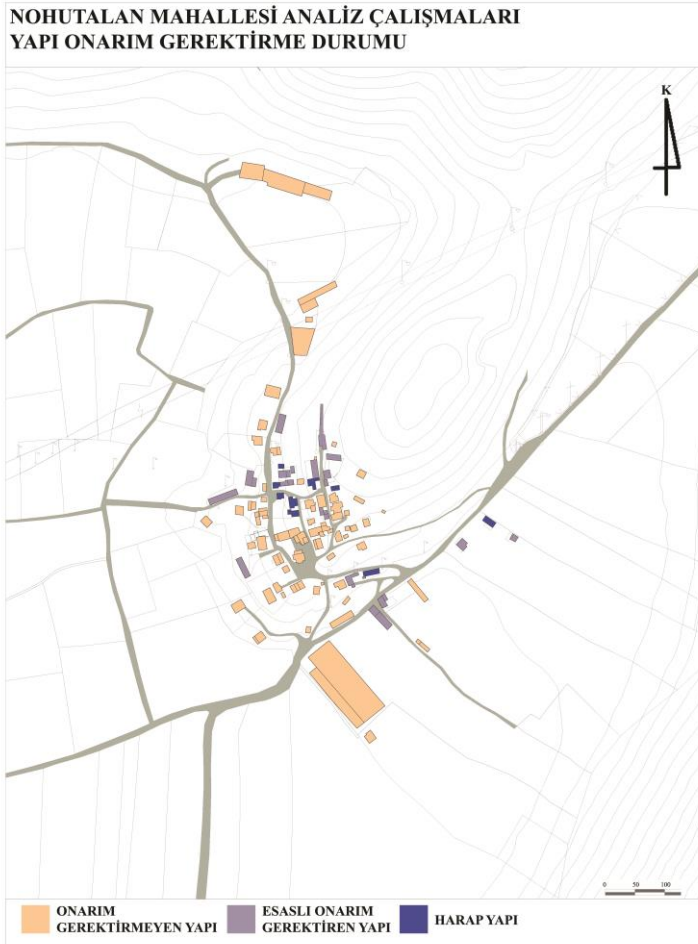
Şekil 41. Nohutalan yapı onarım gerektirme durumu analizi
