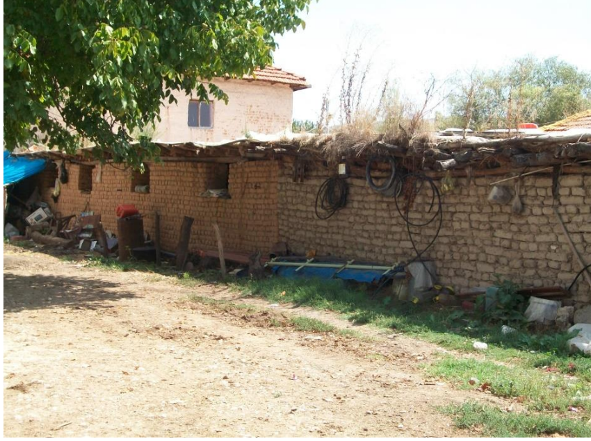
Fotoğraf 11. Cumhuriyet Köyü'nde Taş Duvarlı, Çatısı Sazlıklardan Yapılmış Düz Toprak Damlı Ahır. Araştırma sahasında yer alan Karakuyu Gölü'nde sazlıkların yoğun olarak bulunmasından dolayı eski mesken ve ahırların çatıları yöreden temin edilen sazlıklarla kaplanıp, üstleri toprakla örtülmüştür.
