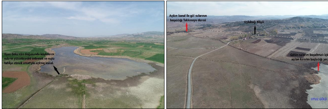
Foto 7. Uyuz Gölü'nün sularının fazla yükselmesini engellemek için açılan kanalın drone ile alınmış görüntüleri.
