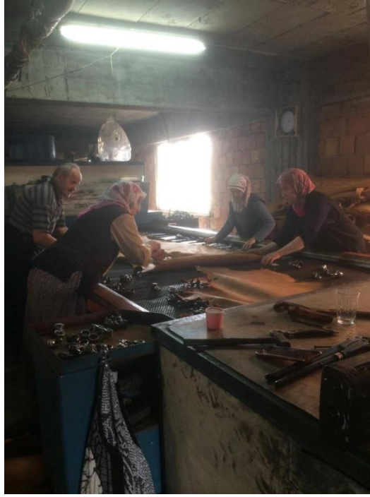
Fotoğraf 23. Otomatik gergi makinesinde derinin gerilmesi (Akasya Deri, 2018).
