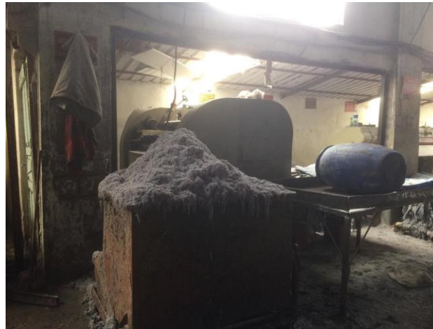
Fotoğraf 11. Deriden makine yardımı ile uzaklaştırılmış kıllar (Tezcan Deri, 2018).
