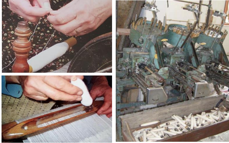
Görsel 8: Atkı ipliklerinin geleneksel yöntemlerle hazırlanması ve atkı ipliklerinin yarı otomatik atkı sarma makinasında oluşturulması, Mehmet Akgün atölyesi (sağ görsel).
