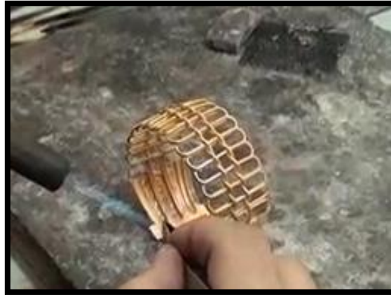
Fotoğraf 17. Kıvratma tellerin kaynatılması
