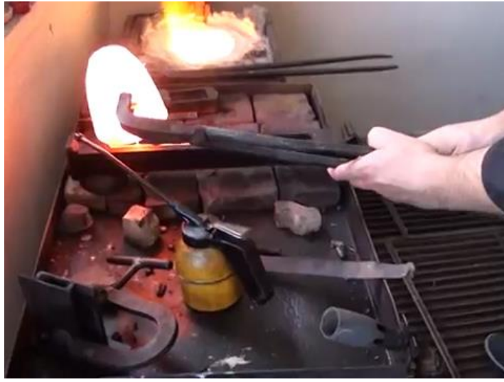
Fotoğraf 5. Altının tel dereceye dökülmesi
