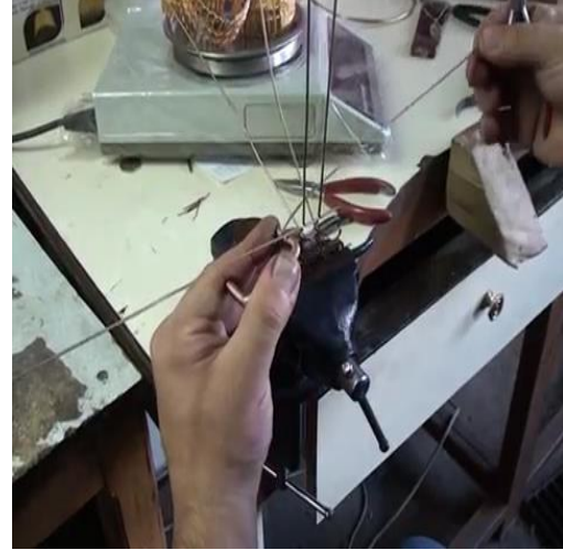
Fotoğraf 9: Tellerin mengeneye sıkıştırılması
