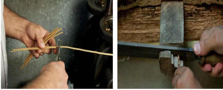
Fotoğraf 16. Kıvratma tellerin hazırlanması
