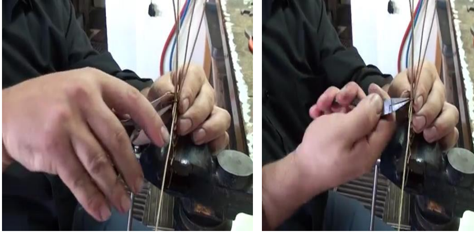
Fotoğraf 13. Kayseri burmasına demir tellerin bağlanması
