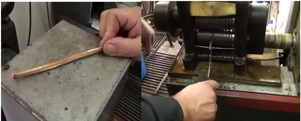
Fotoğraf 6. Silindirden çekilen altın tel
