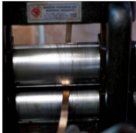
Fotoğraf 18: Silindirde çekilen astar
