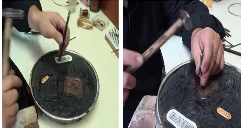
Fotoğraf 20. Desen aktarma işlemi
