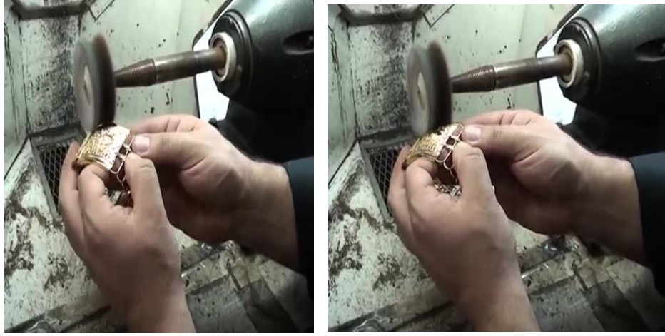
Fotoğraf 27. Kayseri burmasının cilalanması
