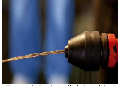
Fotoğraf 15. Altın telin büküm işlemi
