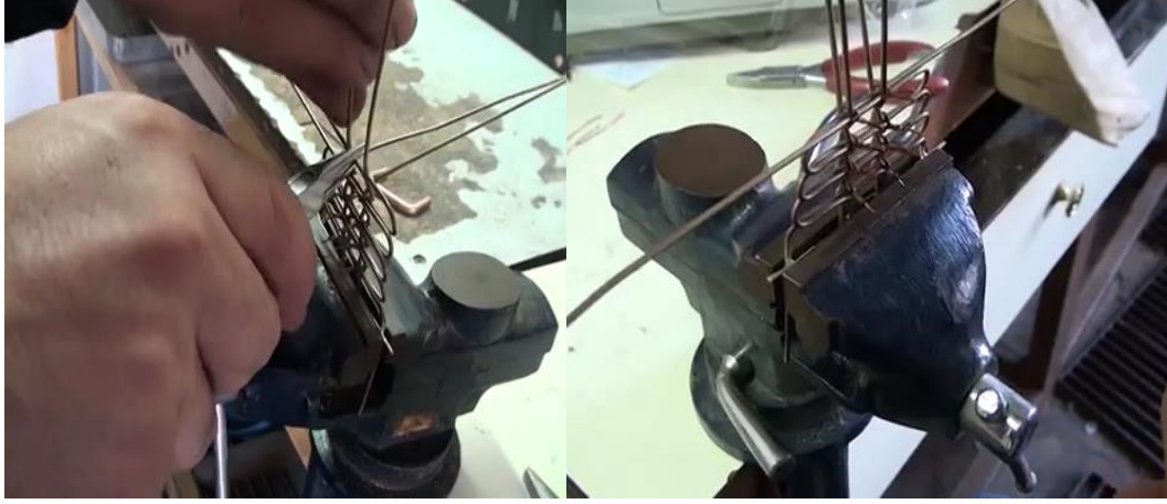
Fotoğraf 11. Tellerin pense ile bükülmesi
