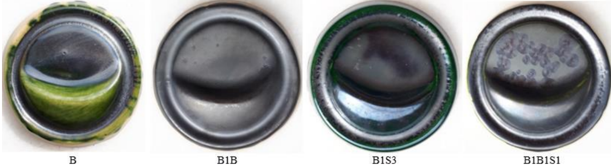
Şekil 3:B, B1B, B1S3, B1B1S1 standart reçetesinin boraks ve sülyen katkılı pişirim sonrası elde edilen yüzey görüntüleri.
