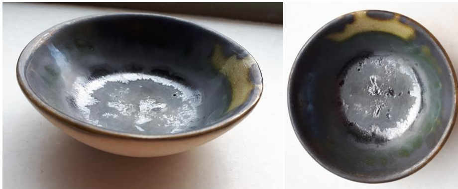
Şekil 6: B1B kodlu metalik sır kullanılmıştır. Pişirim sıcaklığı 1200°C’dir.
