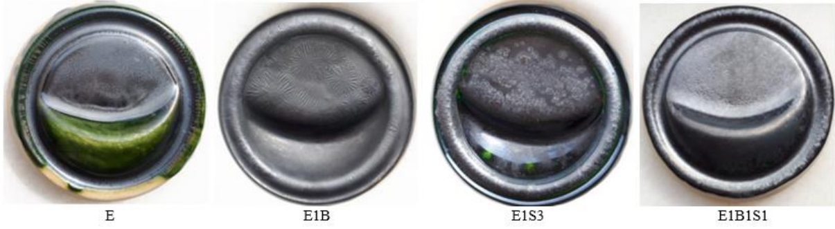
Şekil 4: E1B, E1S3, E1B1S1 standart reçetesinin boraks ve sülyen katkılı pişirim sonrası elde edilen yüzey görüntüleri.
