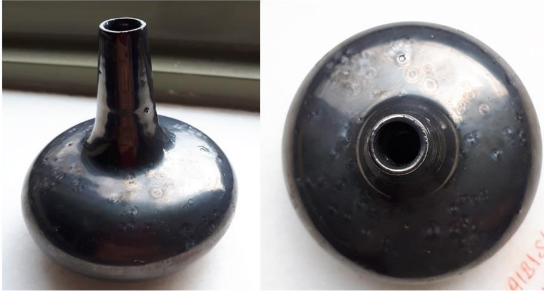
Şekil 7:A1B1S1 kodlu metalik sır kullanılmıştır. Pişirim sıcaklığı 1100°C'dir.
