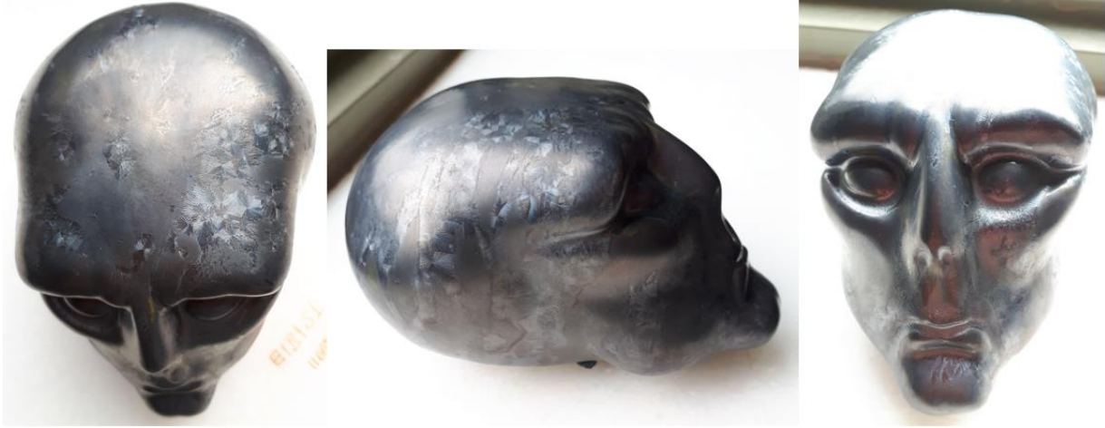
Şekil 8: B1B1S1 kodlu metalik sır kullanılmıştır. Pişirim sıcaklığı 1100°C'dir.
